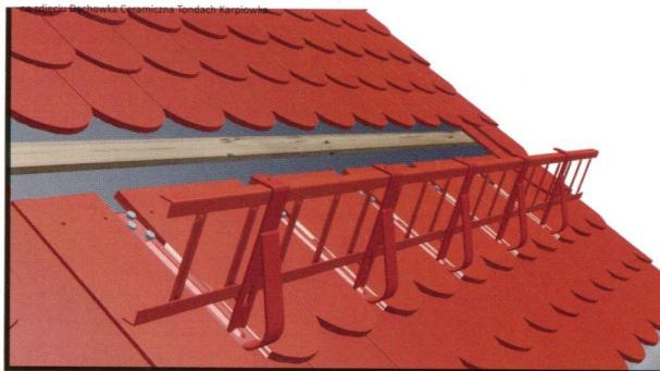
Po upevnení požadovaného počtu držiakov S je treba namontovať protisnehový plot. Plot montujeme v držiaku pomocou zapínania.
